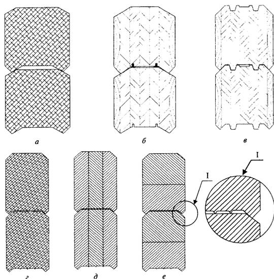
*a* — трапецидальный венцовый паз; *б* — трапецидальный венцовый паз с канавкой для уплотнителя; *в* — соединение «шпунт-гребень» с пазом для плоского уплотнителя; *г* — трапецидальный венцовый паз с уплотнителем в виде сминаемых треугольных гребней древесины; *д, е* — то же, для клееных брусков
