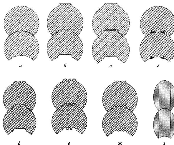
*a* — простой цилиндрический венцовый паз; *б* — трапецидальный венцовый паз; *в* — трапецидальный венцовый паз с канавкой для плоского уплотнителя; *г* — простой цилиндрический венцовый паз с канавками для уплотнителя; *д* — трапецидальный венцовый паз с канавками для уплотнителя; *е, ж* — трапецидальный венцовый паз с соединением «шпунт-гребень»; *з* — простой цилиндрический венцовый паз для эллиптического бревна из клееной древесины
